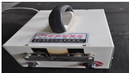
图 7-6-1 电热自动断喙器
